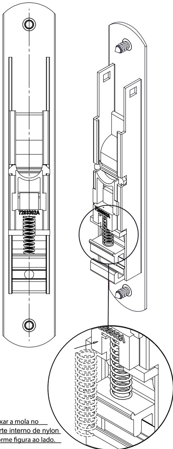
Encaixar a mola no suporte interno de nylon conforme figura ao lado.
